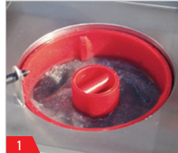
1 Brillantatura magnetica. / Magnetic polishing. / Magnetisches Glanzschleifen. / Brillantage magnétique.
