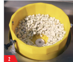
2 Lavorazione ad acqua con abrasivo. / Water processing with abrasive. / Nassbearbeitung mit Schleifmittel. / Usinage à l'eau avec abrasif.
