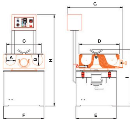
**LM** Vibratore triangolare con vasca in poliuretano antiabrasivo, con scarico materiale e pannello digitale completo di variatore di velocità.
